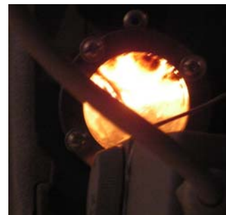
IV. 10. kép. A betekintő nyíláson keresztül látható az égőkossárban égő tűz.
