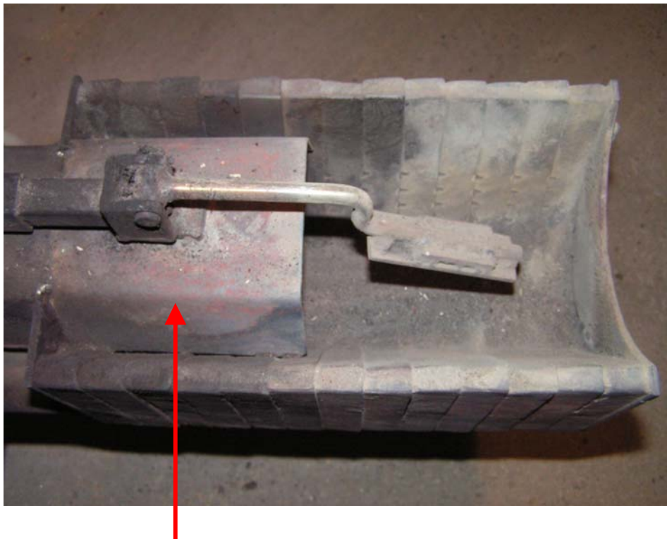
I. 3. kép. A kosárszint érzékelő tartó lemeze a csigaprofilhoz lett igazítva.
